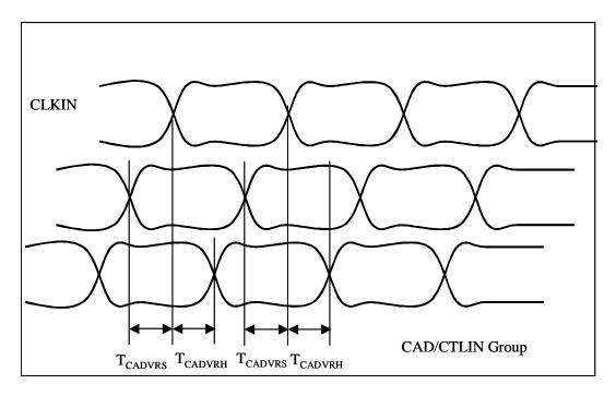
Figure 47.  $T_{CADVRS}/T_{CADVRH}$
